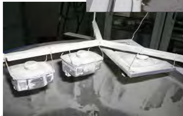
Kula fotometryczna z badanym źródłem światła
